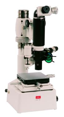
В качестве источника света в микротвердомере используется светодиод белого свечения, который обеспечивает равномерное освещение и более контрастное изображение объекта.
